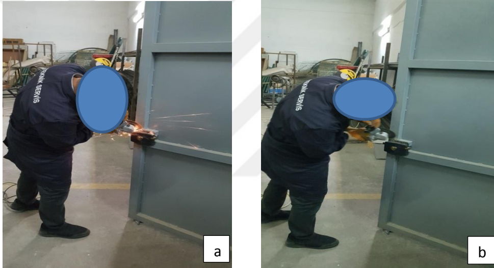
Fotoğraf 29: Spiral Aleti Yardımıyla Kilit Sökülme İşlemi(a,b))
