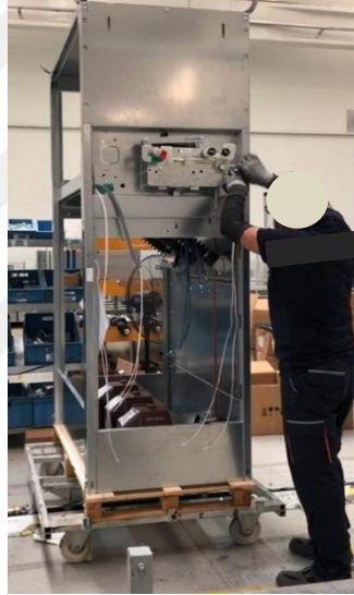
Şekil 39 Kapı kilit basma sacı montaj işlemi alt faaliyet adımı
