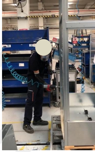
Şekil 24 Operatörün arka alt kapama sacının havalı perçin sıkıcı ile montaj işlemi
