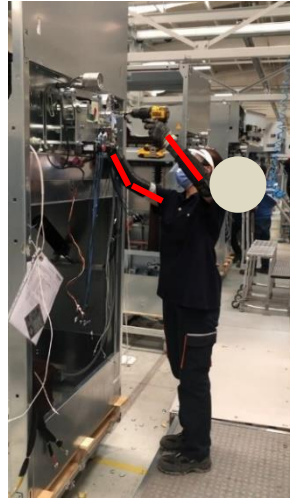
Şekil 45 Açma kapama bobin montaj işlemi alt faaliyet adımı
