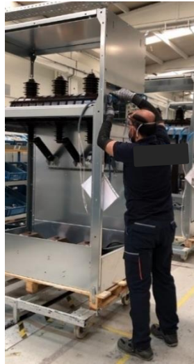
Şekil 38 Operatörün kablo düzenleme montaj alt faaliyet adımı
