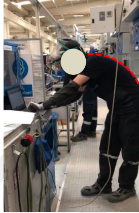
Şekil 76 Röle akım testi uygulama alt faaliyet adımı
