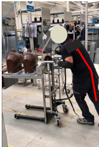
Şekil 30 Trafoların stok alanından montaj hattına taşınması alt faaliyet adımı
