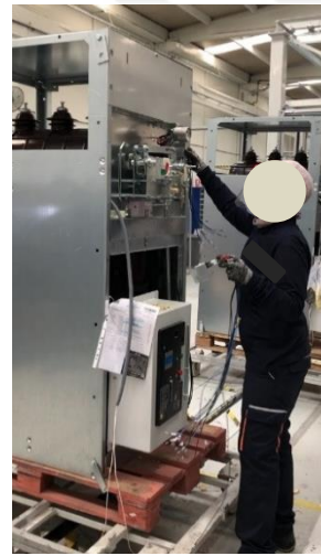
(a) Kilit basma sacı hazırlık alt faaliyet adımı (b) Yük ayırıcı ve toprak switchi montaj alt faaliyet adımı
