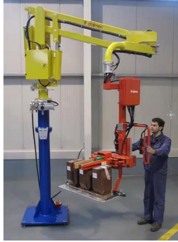
Şekil 81 Trafoların hücre içerisine montajı için kullanılan manüplatör
