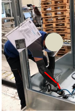
Şekil 21 Operatörün ısıtıcıyı hücre içerisine havalı tork sıkıcı ile montaj işlemi
