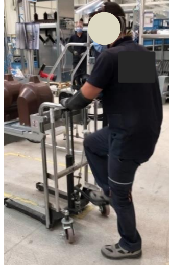
Şekil 31 Taşıma arabasını frenleme ve ayak pedalı ile kaldırma işlemi
