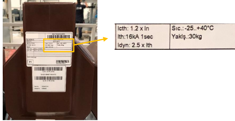
Şekil 29 Bir adet akım trafosunun ağırlığı
