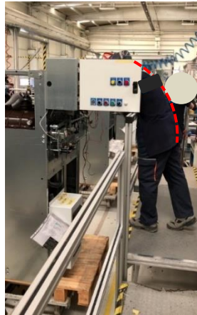
Şekil 62 Pano switch bağlantıları montajı alt faaliyet adımları sırasındaki vücut duruşu
