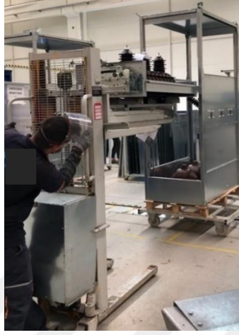
Şekil 32 Ayırıcı kazanlarının taşıma ekipmanı ile hücre içesine aktarılması alt faaliyet adımı ve operatörün görüş mesafesi
