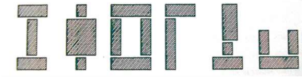
Şekil 5. 9: Dilatasyon İle Yapı Ayırma Örnekleri (Hünük,2006)
