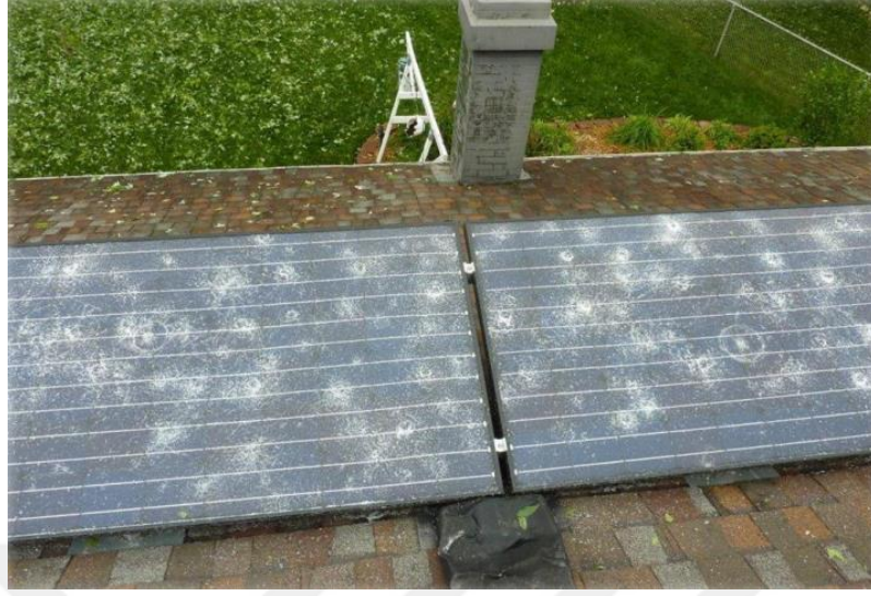
Őekil 6. 22 : Dolu Afeti Sonrası Panel Durumu
