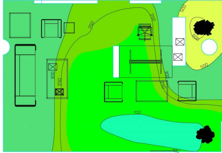
Şekil 4.39: 1B Mekanı 2. İyileştirme Aydınlık Düzeyi Dağılımı Gösterimi
