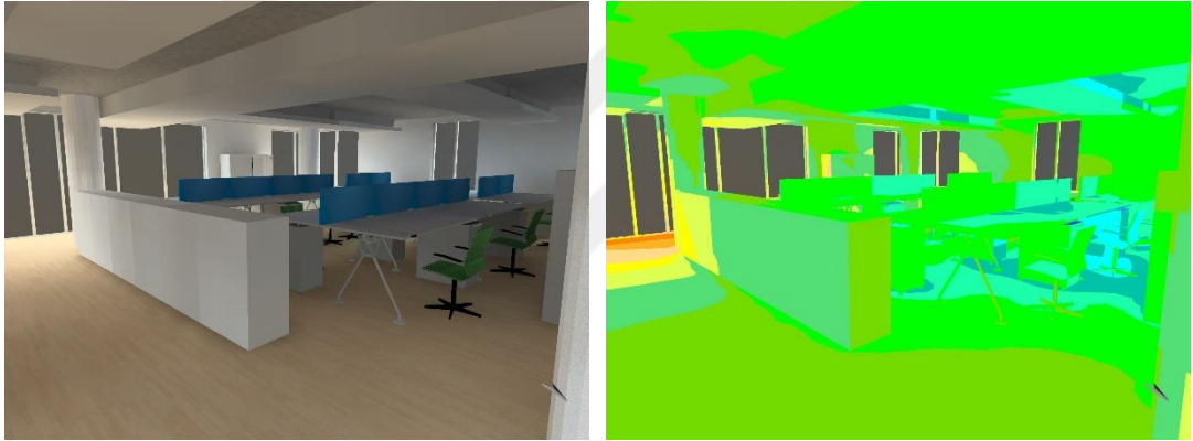
Şekil 4.54: 1A Mekanı 4. İyileştirme Aydınlık Düzeyi Dağılımı Render Gösterimi
