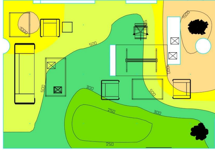
Şekil 4.55: 1B Mekanı 4. İyileştirme Aydınlık Düzeyi Dağılımı Gösterimi
