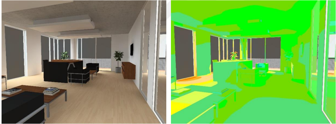
Şekil 4.56: 1B Mekanı 4. İyileştirme Aydınlık Düzeyi Dağılımı Render Gösterimi
