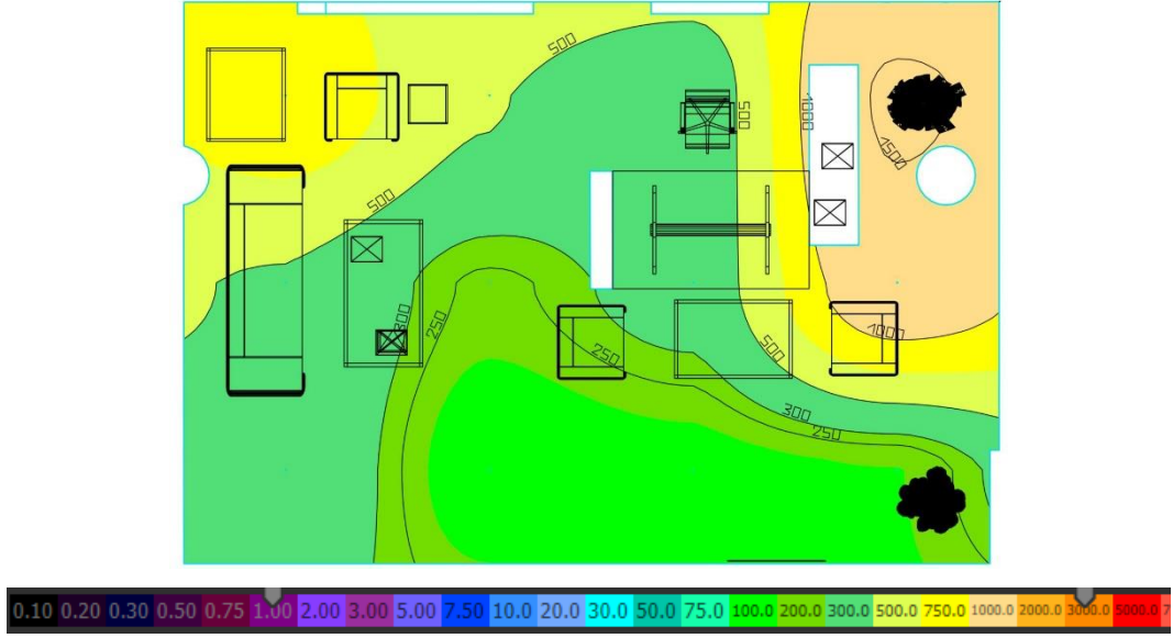
Şekil 4.47: 1B Mekanı 3. İyileştirme Aydınlık Düzeyi Dağılımı Gösterimi
