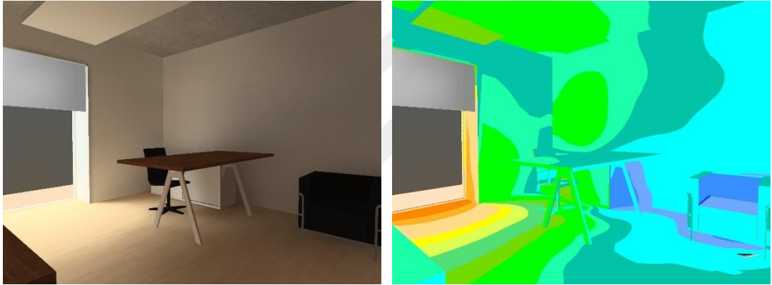
Şekil 4.42: 1C Mekanı 2. İyileştirme Aydınlık Düzeyi Dağılımı Render Gösterimi
