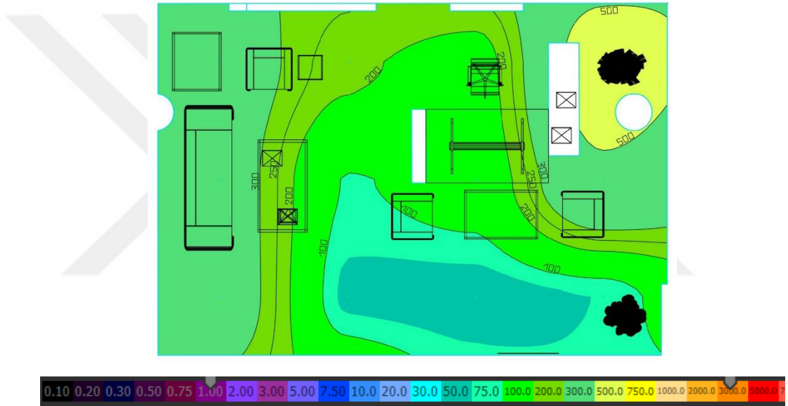
Şekil 4.23: 1B Mekanı Aydınlik Düzeyi Dağılımı Gösterimi
