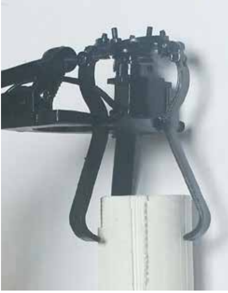
Şekil 7. Üretimi yapılan gripper sisteminin silindirik bir parçayı kavraması
