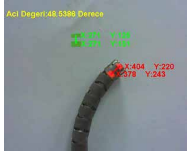
Şekil 6 Uç işlevci pozisyonunun doğrulanması
