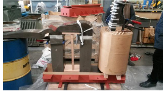
Şekil 11. Amorf çekirdekli prototip transformatör imalatı
