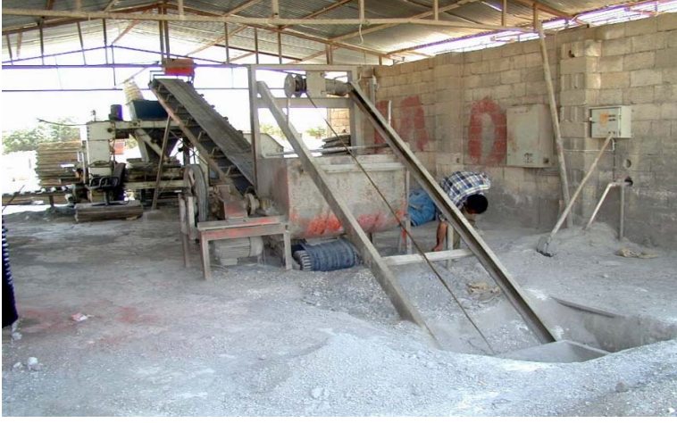
Resim 6. Parke Taşı Tesisinde Kerpiç Blok Üretimi
