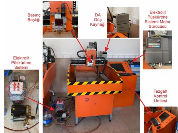
Şekil 3. EJİ tezgahı (EJM machine)
