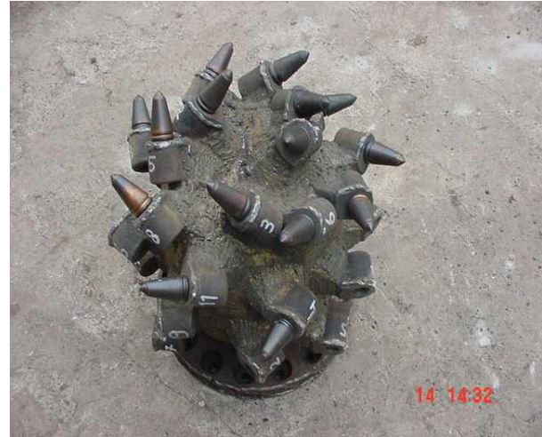
Şekil 3. İmalatı Bitirilmiş Bir Kesici Kafanın Görünüşü.
