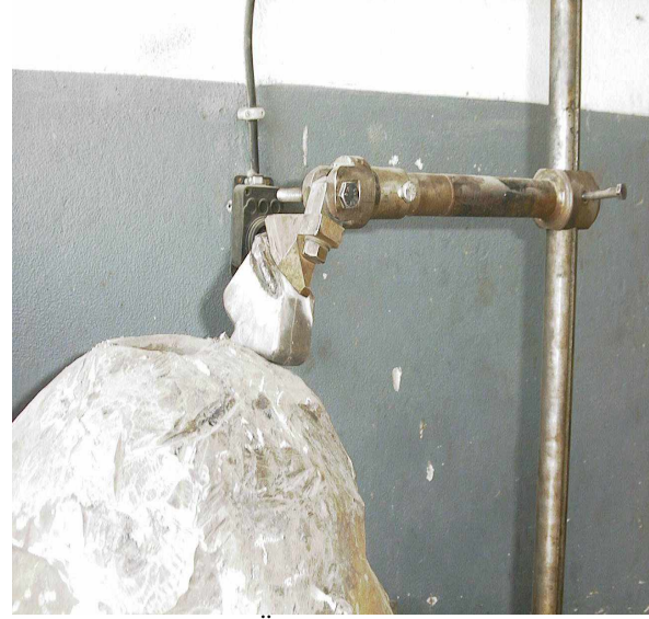
Şekil 2. Koordinat Ölçme Düzeneği ile Kesici Kafa Üzerine Keski Tutucu Yerleşimi
