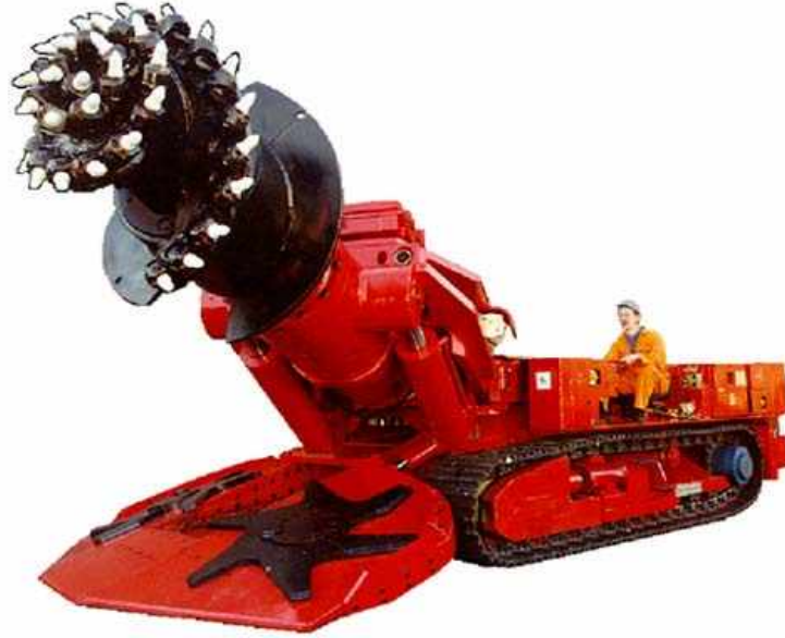
Şekil 1. Kollu Tip Bir Galeri Açma Makinasının Genel Görünüşü Figure 1. General View of a Boom Type Roadheader
