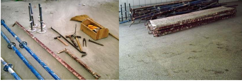
Şekil 23: Kullanılacak iskele malzemeleri ve ekipmanlar.
