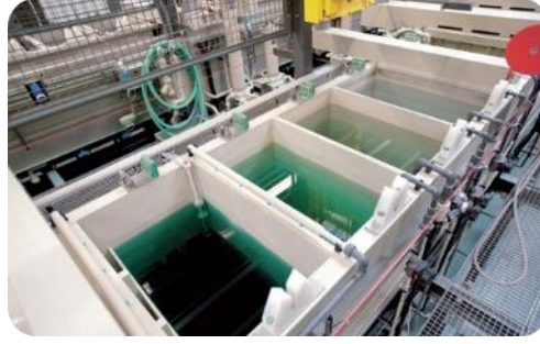
Şekil 8: Nikel kaplama banyosu [20].
