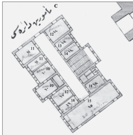
FIG. 14 ADMINISTRATIVE BUILDING SECOND FLOOR PLAN: C – UREDI, 10 – PROSTORIJA ZA UPRAVITELJA ZATVORA, 11 – PROSTORIJA ZA POLICIJSKOG SLUŽBENIKA, 12 – TAJNIŠTVO, 13 – PROSTORIJA ZA LIJEČNIKA, 14 – PORTIRNICA, 15 – PROSTORIJA ZA 20 ČUVARA, 16 – PROSTORIJA ZA 2 GLAVNA ČUVARA, 17 – PROSTORIJA ZA POSLUŽITELJA, 18 – PROSTORIJA ZA PRITVOR SL. 14. TLOCRT DRUGOG KATA UPRAVNE ZGRADE: C – UREDI, 10 – PROSTORIJA ZA UPRAVITELJA ZATVORA, 11 – PROSTORIJA ZA POLICIJSKOG SLUŽBENIKA, 12 – TAJNIŠTVO, 13 – PROSTORIJA ZA LIJEČNIKA, 14 – PORTIRNICA, 15 – PROSTORIJA ZA 20 ČUVARA, 16 – PROSTORIJA ZA 2 GLAVNA ČUVARA, 17 – PROSTORIJA ZA POSLUŽITELJA, 18 – PROSTORIJA ZA PRITVOR
