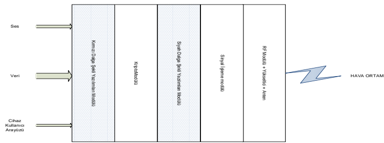
Şekil 1. SIMEMSIS açısından genel telsiz yapısı
