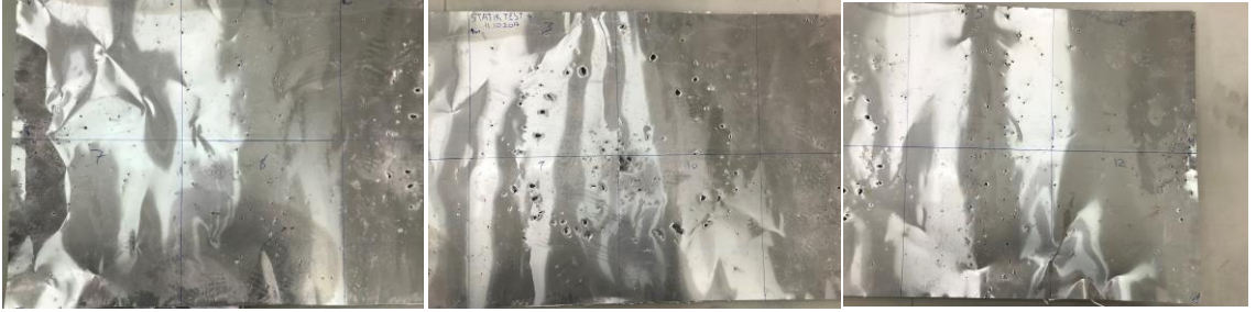
Şekil 6. Test 4- Patlama sonrası hedef plaka, sırasıyla sol- orta-sağ kısım.
