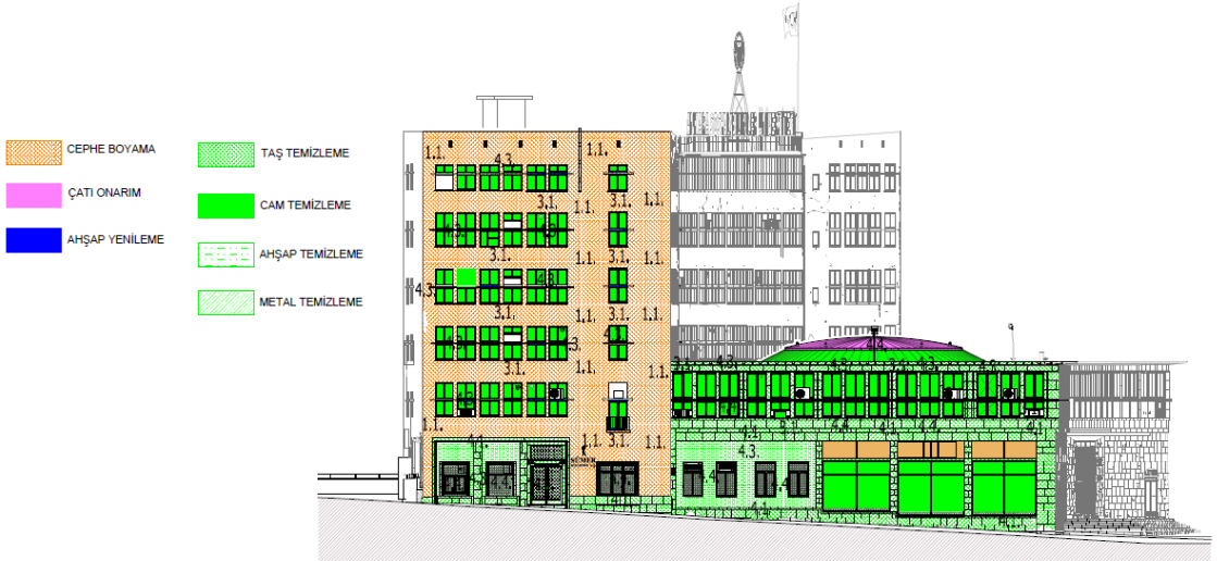
RESTORASYON KUZEY CEPHESİ
