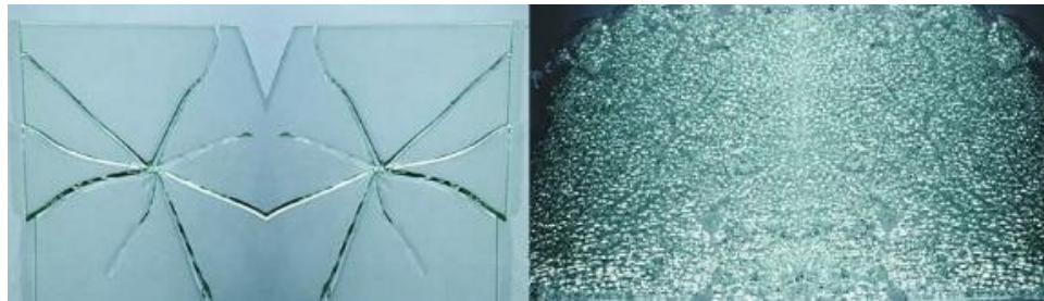
Şekil 3.12. Kırık Düz Cam ile Kırık Temperli Cam Örneği (URL-14)
