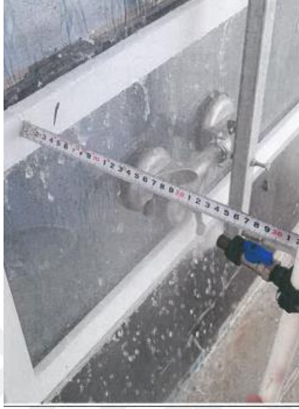
Şekil 5.48. Cephe Test Mesafe Ölçümü (Kişisel Arşiv-2019)
