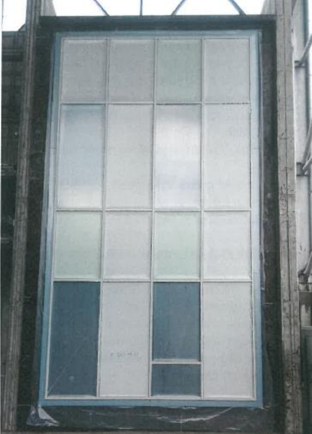
Şekil 5.28.Cephe Test Modülü (Kişisel Arşiv-2019)
