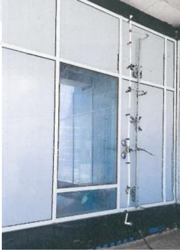
Şekil 5.47. Cephe Testi Modülü (Kişisel Arşiv-2019)
