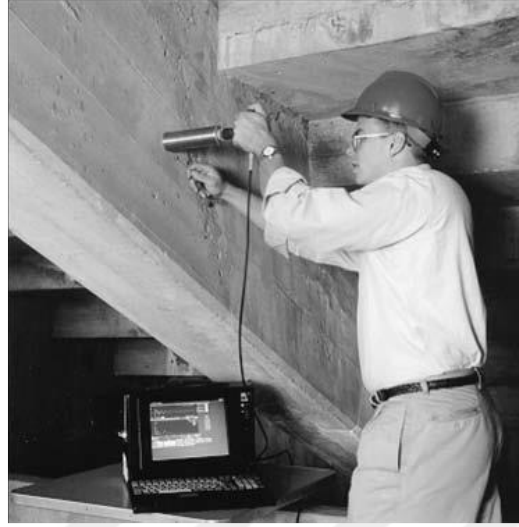
Şekil 5. 16: Darbe-eko muayene cihaz örneđi (Malhotra ve Carino, 2004)
