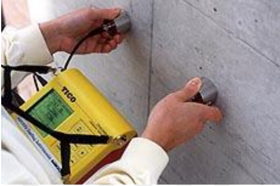
Şekil 5. 14: Ultrases hızı yönteminin beton bir yapı üzerine uygulanması (Türkel)
