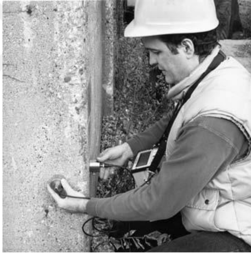
Şekil 5. 13: Ultrases hızı yönteminin beton bir yapı üzerine uygulanması (Malhotra ve Carino, 2004)
