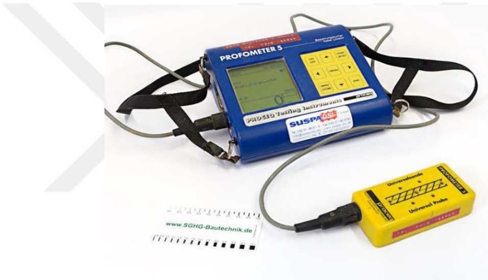
Şekil 5. 26: Donatı tespit aleti (Özhan, 2018)
