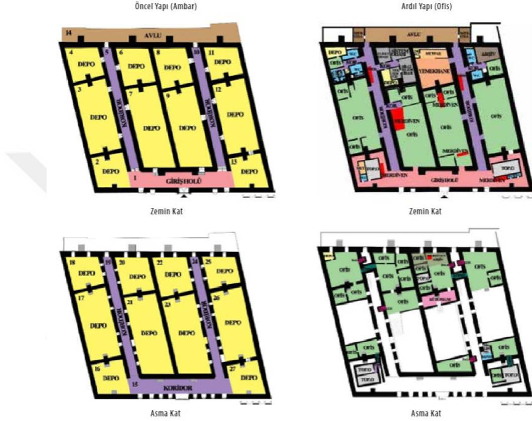
Şekil 63: Kasımpaşa Tuz Ambarı Restorasyon Öncesi (Solda) ve Sonrası Kat Planları (Sağda) (Faiz Büyükçam 2018)
