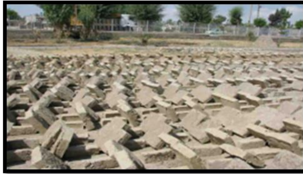
Şekil 2.7: Çapraz Dizilimlerle Kerpicin Tüm Yüzeyinin Güneşte Kurutulması (Çavuş vd. 2015:187)
