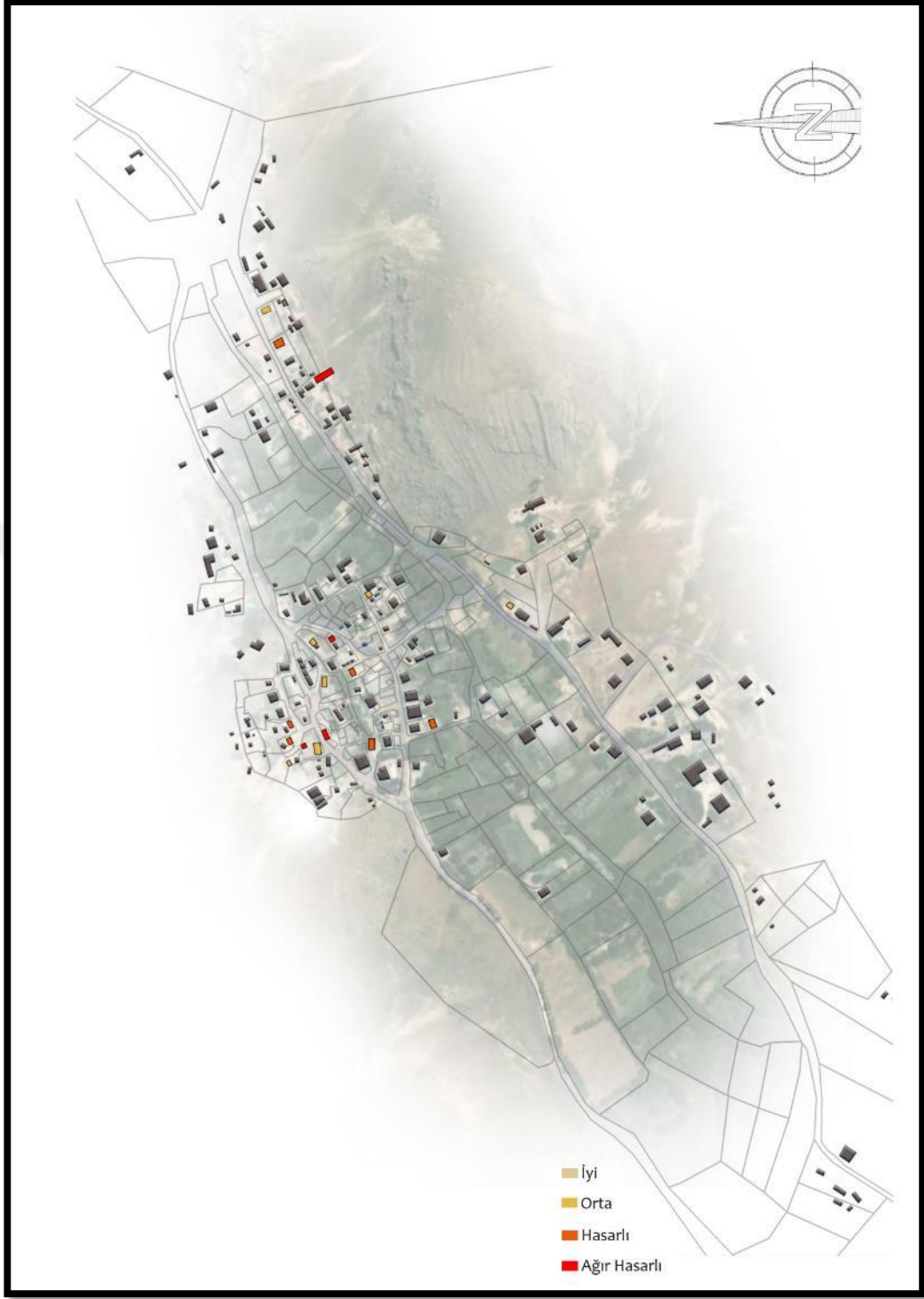
Şekil 3.28: Tekler Mahallesi Kerpiç Evlerin Hasar Durum Analizi
