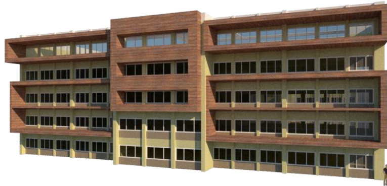
Şekil 48: Okul Yapısı Cephede Güneş Kırıcı Uygulama Önerisi
