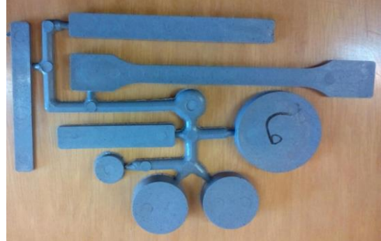
Şekil 4. Enjeksiyon yöntemiyle şekillendirilen %50 baca tozu katkılı kompozit malzeme
