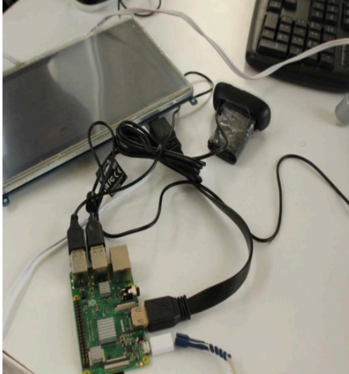
Şekil 4: Prototip çalışmalarından bir görüntü (Raspberry Pi, LCD dokunmatik ekran ve web kamera)
